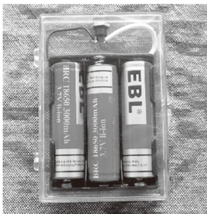
写真6 3本直列したリチウムイオン充電電池
