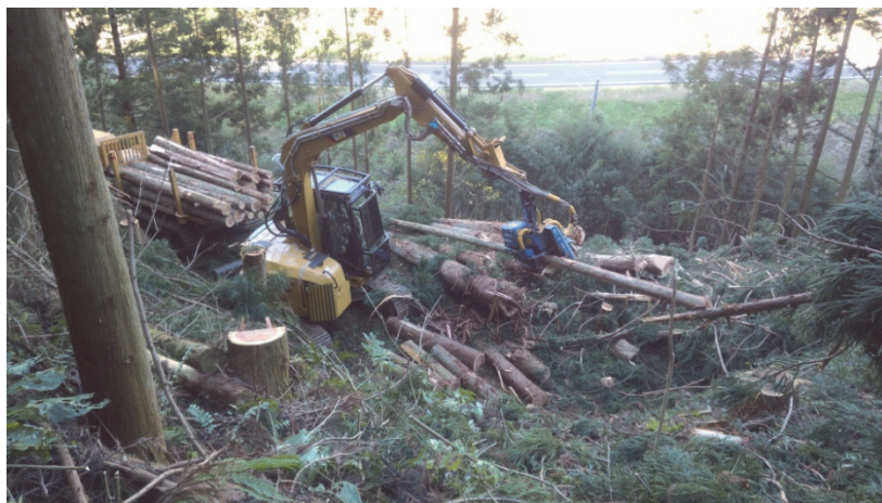
写真－5 皆伐作業のハーベスタによる木寄せ・造材・フォワーダへの積み込み
