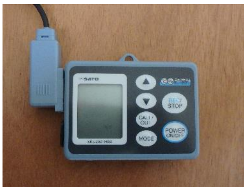
写真 4.2.4-1 温湿度データロガー （(株)佐藤計量器製作所 データロガー記憶計 温度湿度 SK-L200TH II α）
