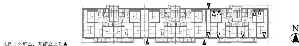
図 3.2.1-3 建築物 C のコア採取位置（3 階と基礎立上り部の例）
