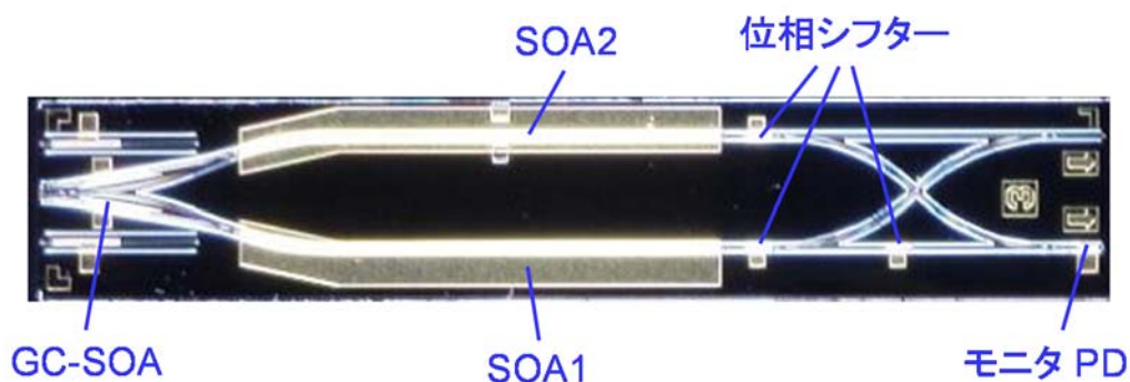
図5.12 試作した GC-SOA, モニタ PD 集積波長変換器
