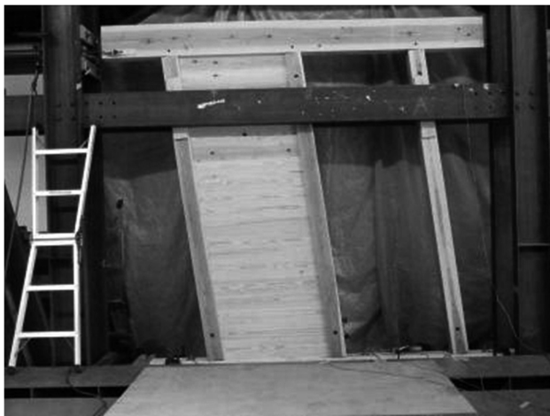
写真5 W試験体の0.125radの最終変形時
