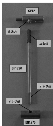
写真 3 部材内蔵型金物の 3 部品
