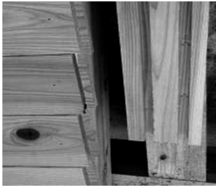
写真4 スギ本実板による柱溝底のめり込み跡との相互のズレ
