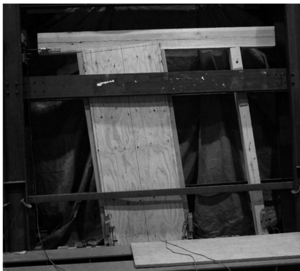
写真 16 P 試験体 0.125rad 最終変形時の状況
