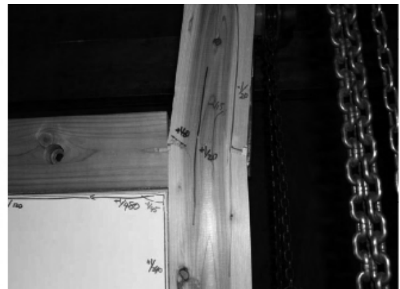
(f) 窓台部加力側柱曲げ破壊
