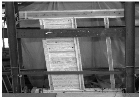
W : 真壁の板張壁の最終変形
