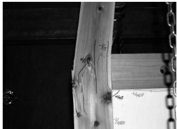
(e) 窓台部中柱曲げ破壊
