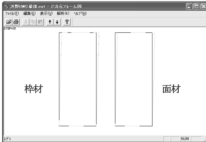
図 3.29 壁上部釘バネが K2 に入り始めた段階
