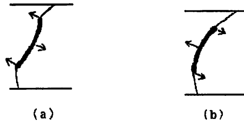
図 3.30: 移動体の屈曲振動
