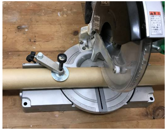
【図1】電動丸鋸による筒の切断
