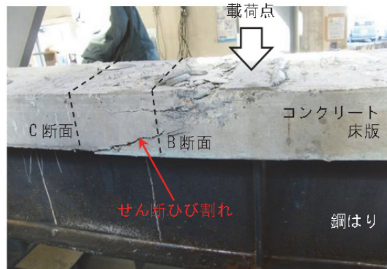
写真 5-1 Type II 試験体に生じたせん断ひび割れ
