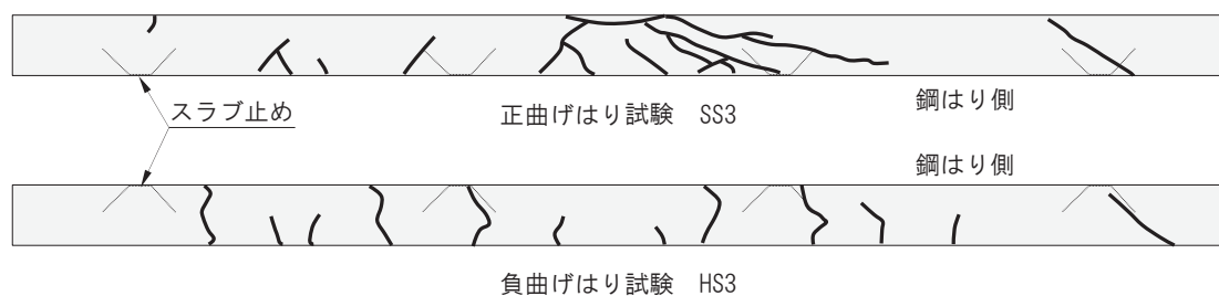
図 3-6 コンクリート床版のひび割れ状況
