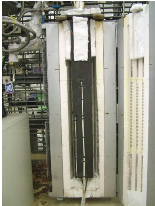
図 3.47 電気炉内に設置した反応管の外観
