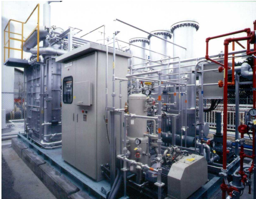
図 3.4 工業用オンサイト水素製造装置
