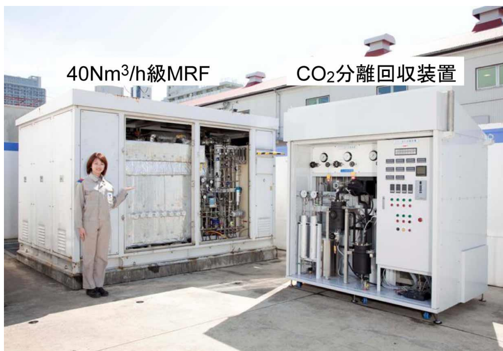
図 3.53 40 Nm 3 /h 級水素分離型リフォーマーと CO 2 分離回収装置
