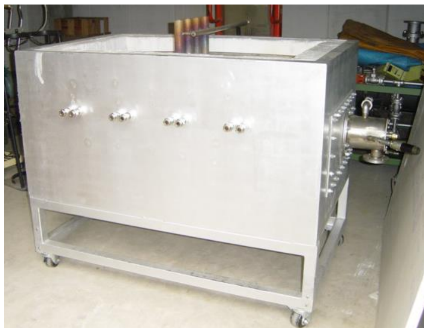
図 3.15 試験用模擬燃焼炉外観
