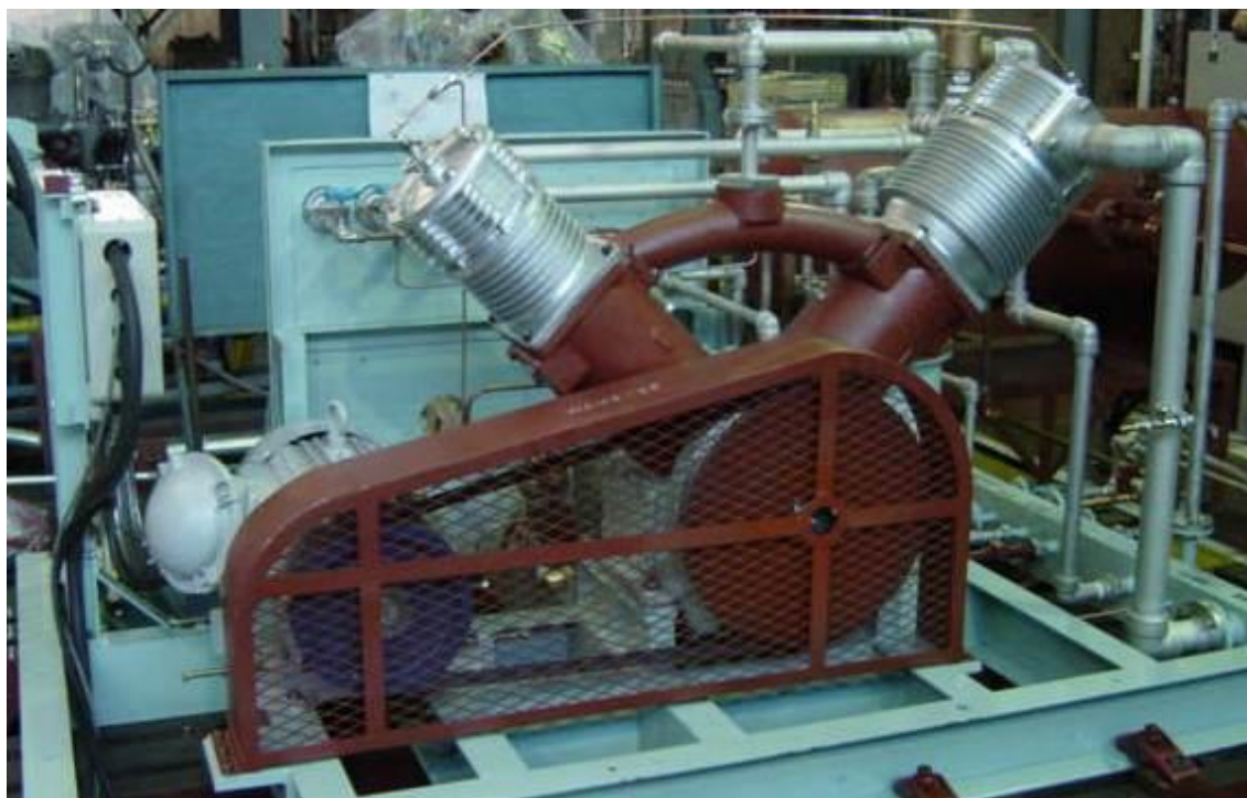
図 3.17 水素吸引ユニット外観（概略寸法：2250 mmW×1350 mmD×1600 mmH）
