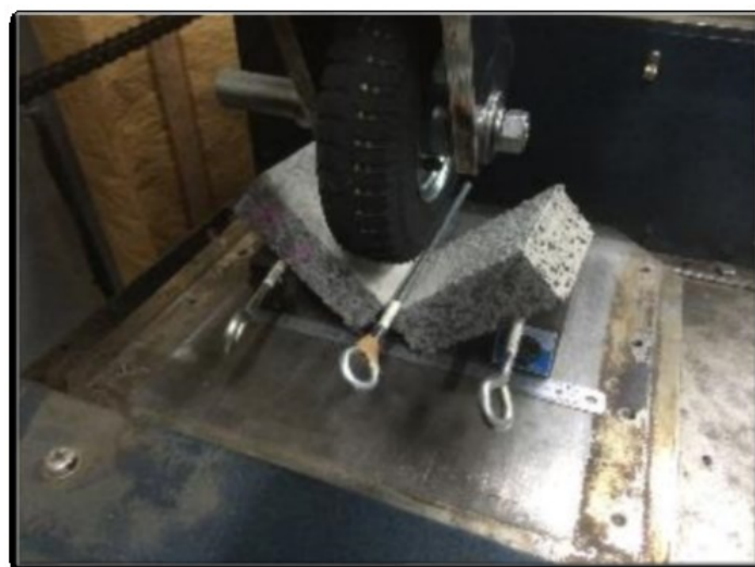
写真 - 3.9 曲げクリープ試験の破壊状況
