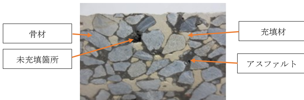
写真 - 3.4 半たわみ性舗装の断面
