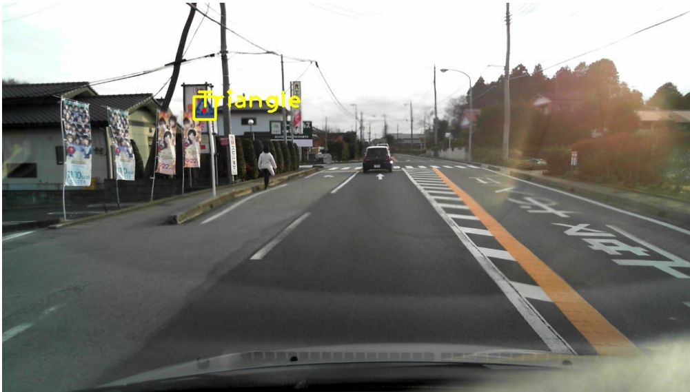
図 4.13 道路標識候補の検出結果の例. (Quadrangle は縦と横の比を用いて長方形 (Oblong) か正方形 (Square) かを判定し結果を表示している)
