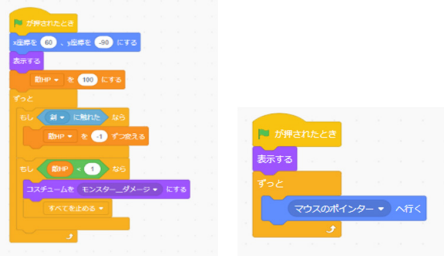
図7 敵モンスターを管理するプログラム（左） ユーザーが操作を管理するプログラム（右）
