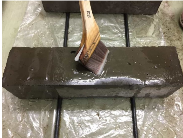
写真-6.6.2 塗布による水溶液含浸の様子
