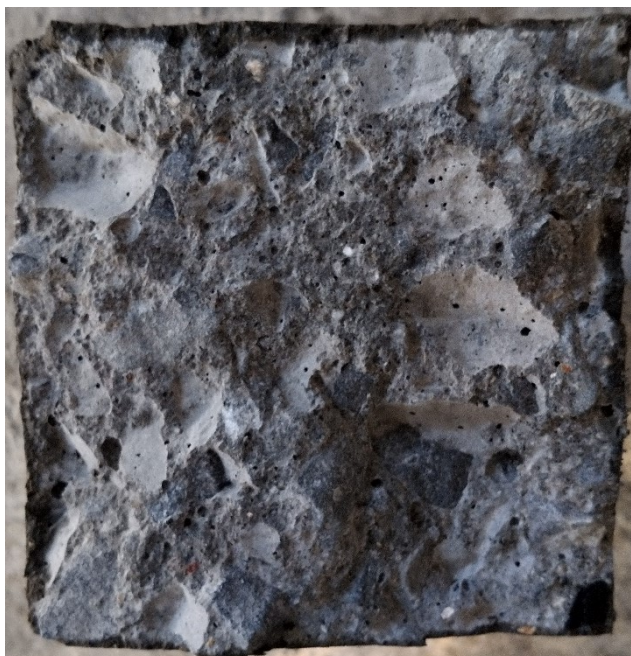
写真-4.3.1 尿素水溶液に1分浸漬した場合の浸透深度
