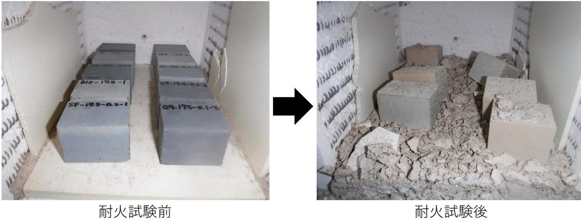
写真-7.1 小型電気炉への供試体の設置状況
