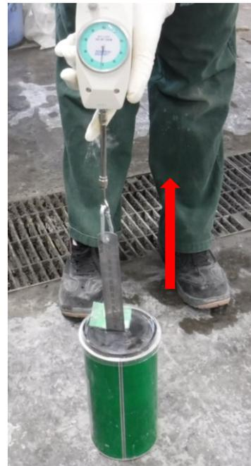
写真-4.5 引張抵抗値試験に用いる機器と測定の概要
