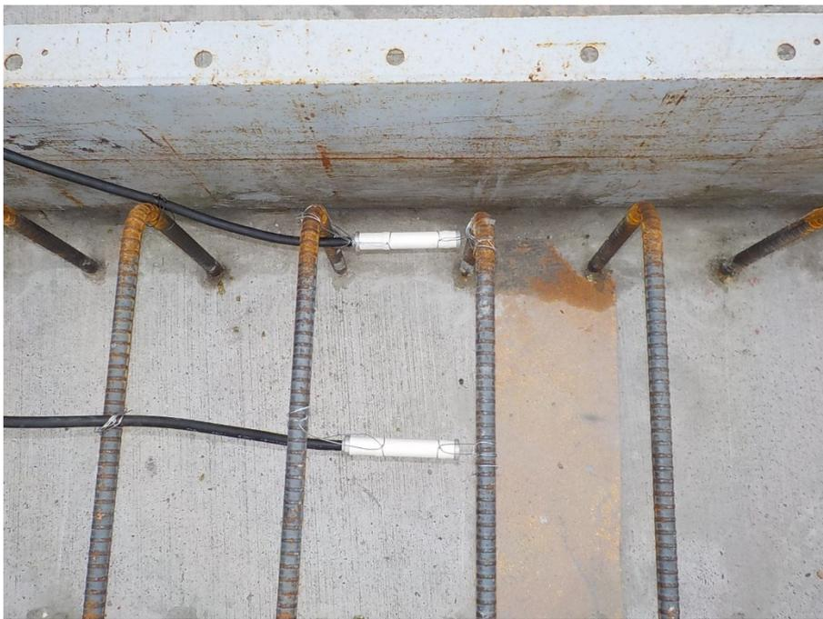
写真-6.7 模擬部材への埋め込みひずみ計の設置状況(中央部と端部から 50mm の位置)
