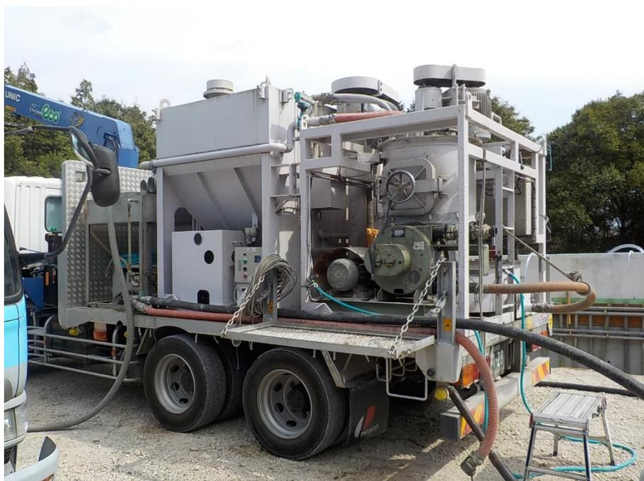
写真-6.9 試験施工に用いた機材（車載プラント供給システム）
