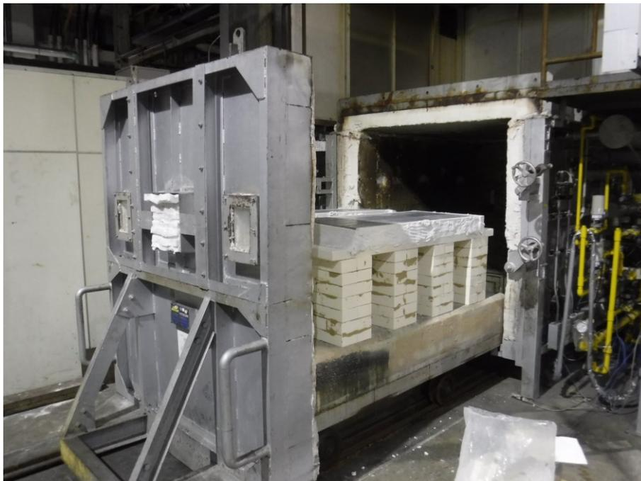
写真-7.3 大型加熱炉
