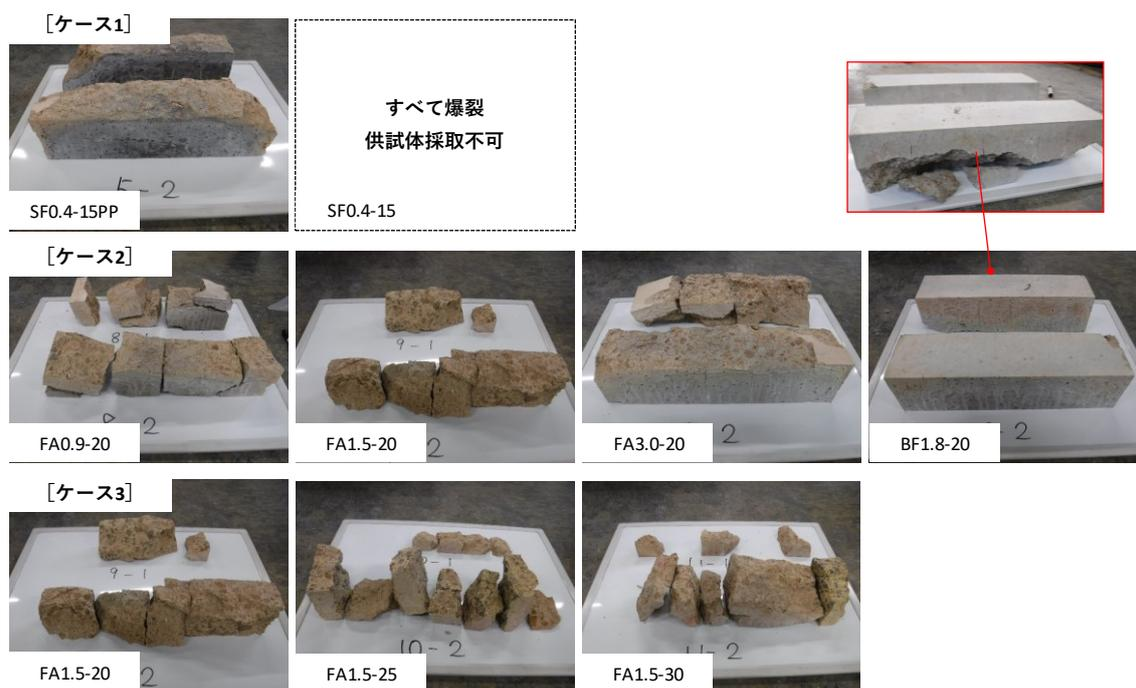
写真-7.5 実験ケースごとの耐火試験後の供試体の状況
