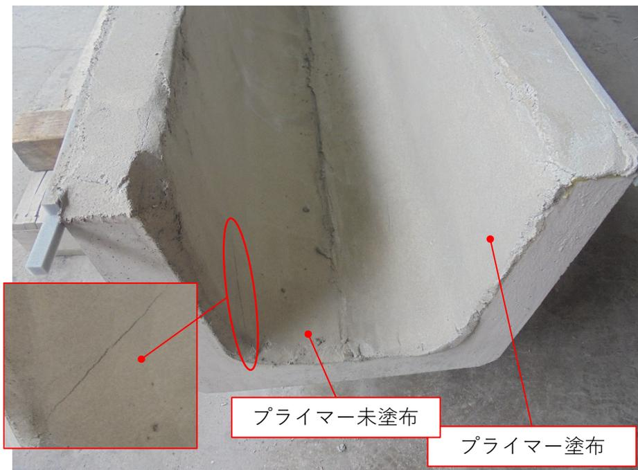
写真-6.20 翌日のひび割れ発生状況
