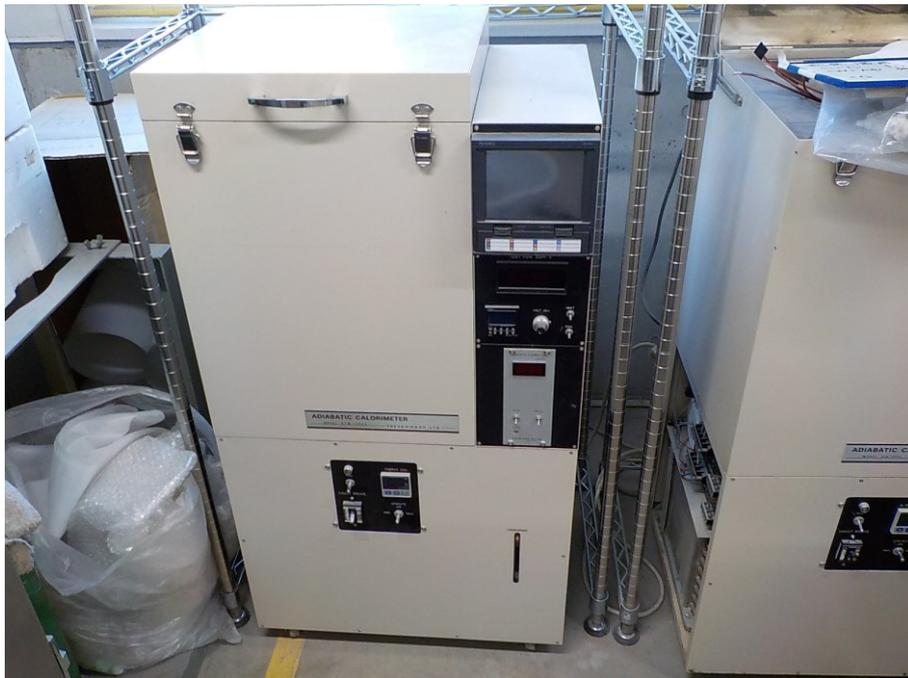
写真-6.1 断熱温度上昇測定装置
