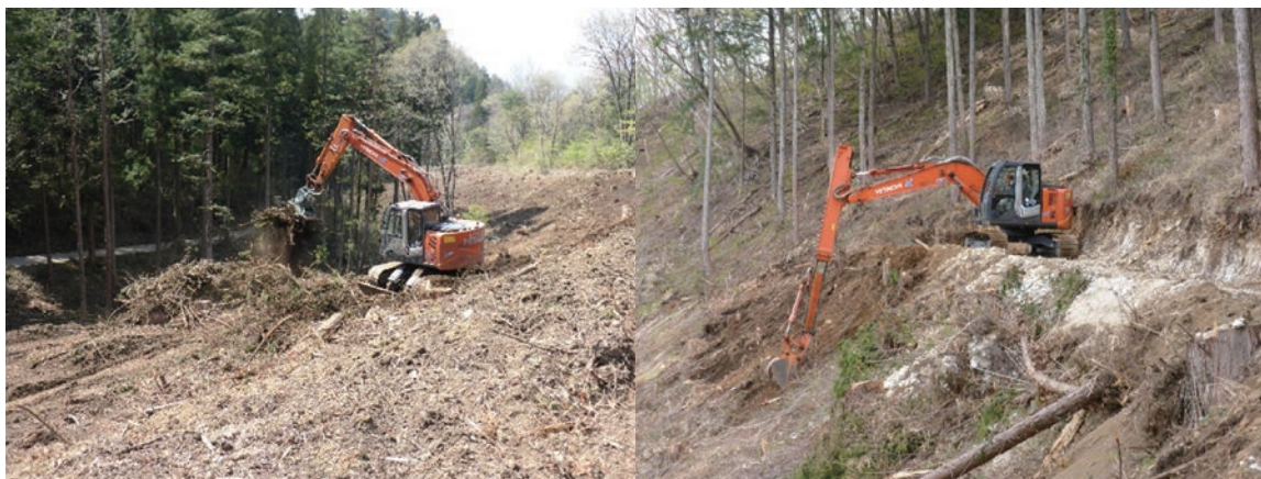
写真-9 調査地 D の地拵え作業 (左: グラップル, 右: ロングリーチバケット)
