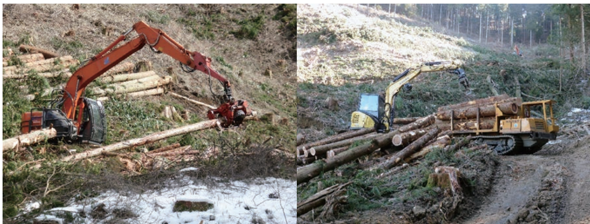
写真-5 調査地Dの皆伐作業（左：プロセッサ造材、右：フォワーダ搬出）
