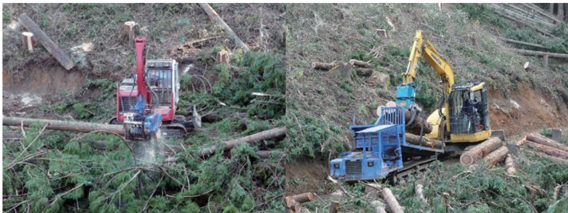
写真-6 調査地Eの皆伐作業（左：プロセッサ造材、右：フォワーダ搬出）
