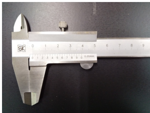
図9. ノギスの本尺(中央部)と副尺(下部)
