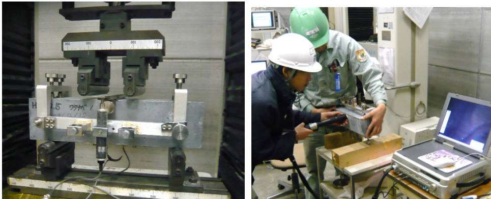
写真 6-2 曲げ供試体へのひび割れ導入状況
