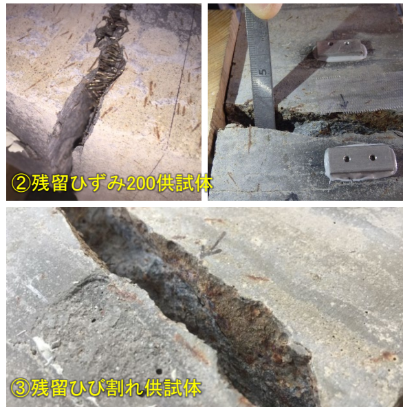
写真 6-5 曲げ疲労試験後の破壊面（繊維消失, 暗い赤褐色）
