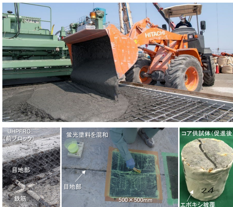
写真 7-3 ひび割れ供試体の作製と浸透プライマーの塗布(模擬床板)
