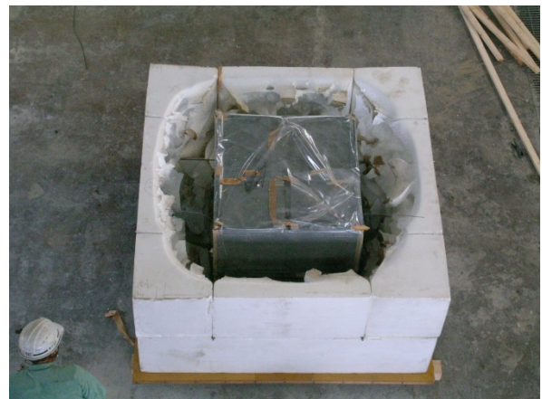
写真3-3 マスブロック解体時の断熱材の状態
