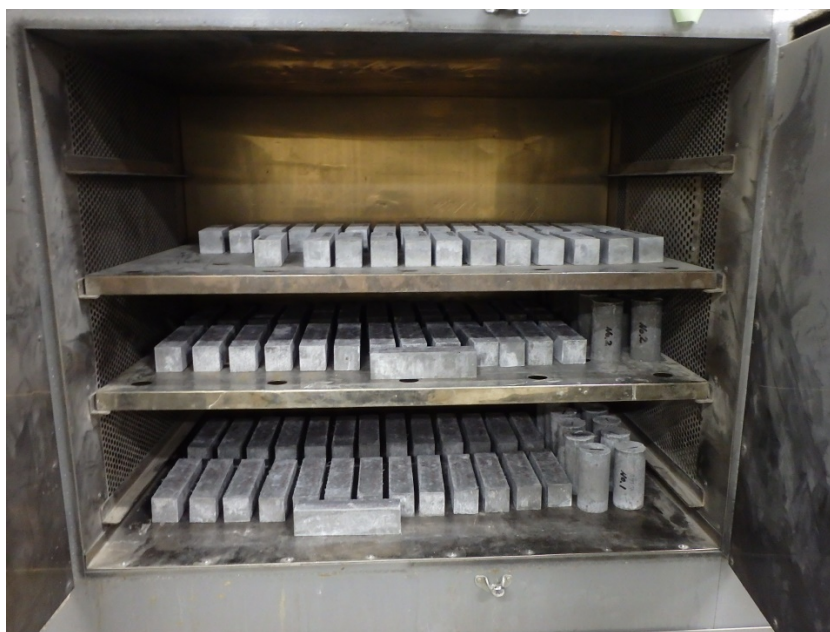
写真 6-10 乾燥炉での暴露状況( 105^\circ\text{C} )
