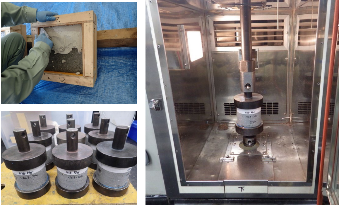
写真 7-4 UHPFRC と断面修復材の一体性確認(直接引張試験)
