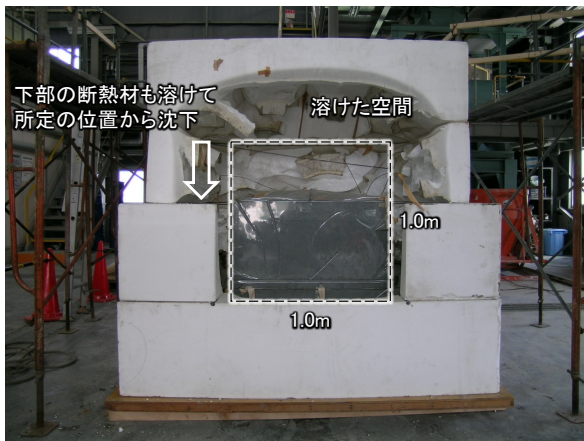
写真3-3 マスブロック解体時の断熱材の状態
