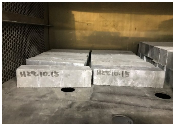
写真 3-4 乾燥炉での暴露状況 (105°C-5 年間)
