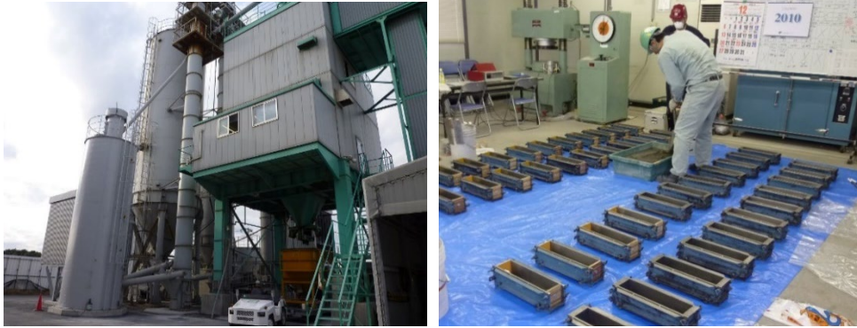
写真 6-1 供試体の作製状況(床板の製作工場にて)
