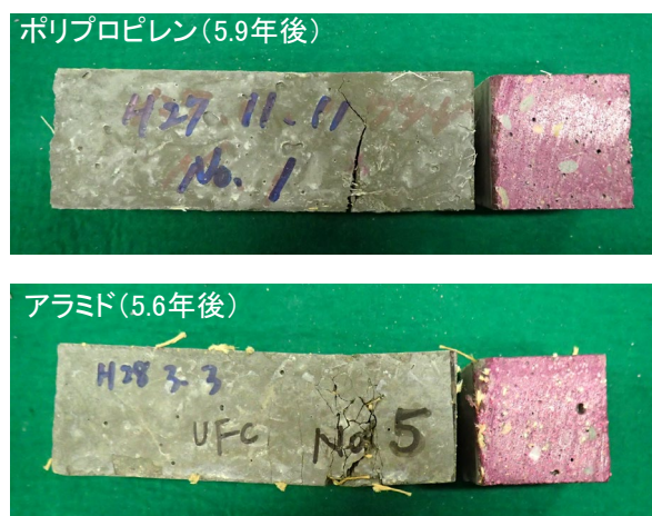
写真 6-11 硬化体のアルカリ保持確認 (フェノールフタレイン噴霧)
