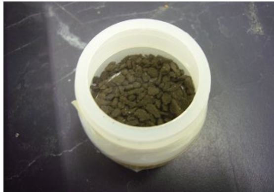
写真 3-1 試験片のアセトン浸漬状況
