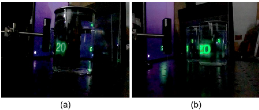
図 109：円柱ガラスを配置した光学系における横方向の視野角の比較。 (a) 物体が光源に接触している配置. (b) 物体が光源から離れている配置.
