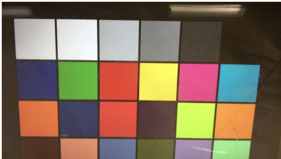
図 22：偏光変調を用いたAIRRにおける装置内カメラ上の偏光板がない場合の観測結果。
