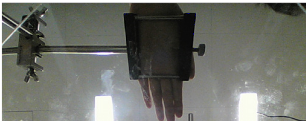
図 27：内部カメラからの手のひらでの散乱光の観測.
