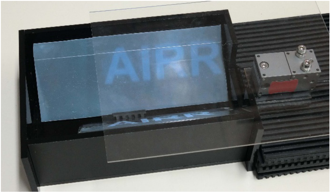
図 68：ビームスプリッターが振動しているときの空中像の撮影結果.
