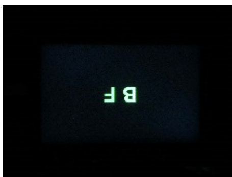
図 59 : ライトフィールドディスプレイに写した奥行差が 4cm ある F と B の文字 (F が手前に飛び出している).
