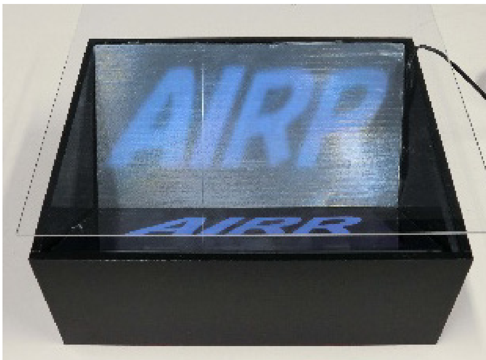
図 73：装置手前に音が抜けるスペースを設けた AIRR 装置.
