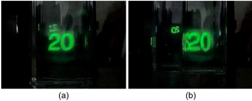
図 107：角柱ボトルの辺を光源に向けた配置での結像実験結果。 (a) 物体が光源に接触している配置. (b) 物体が光源から離れている配置.
