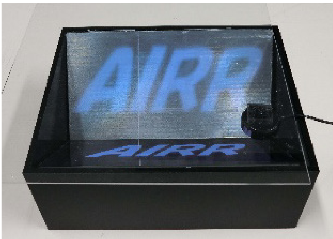
図 71：ビームスプリッターに振動スピーカーを取り付けた場合の AIRR 装置.
