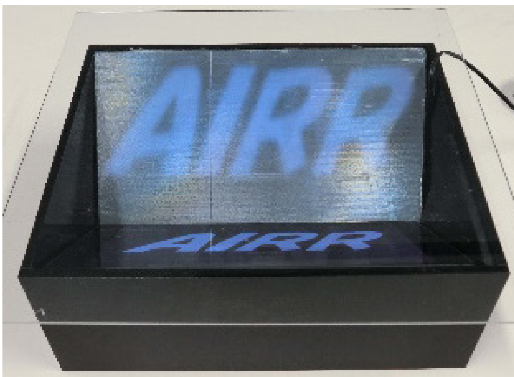
図 72：再帰反射素子に振動スピーカーを取り付けた場合の AIRR 装置.
