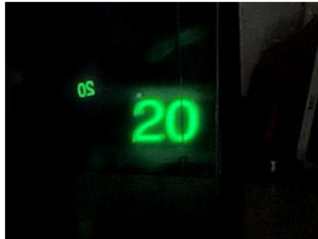
図 105：従来の AIRR 構成によって結像した空中像の撮影結果．
