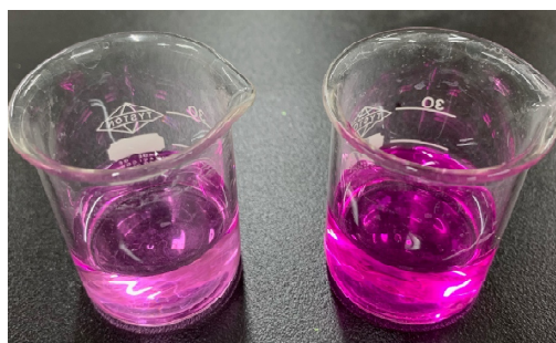
図11. フェノール・フタレインPP(写真の右側)及びそのジアセチル体PP-diAc(同左側)のエタノール溶液を1.0 mol/L NaOHアルカリ性水溶液に滴下したところ[11](アセチル化反応生成物もうすぐ呈色している)
