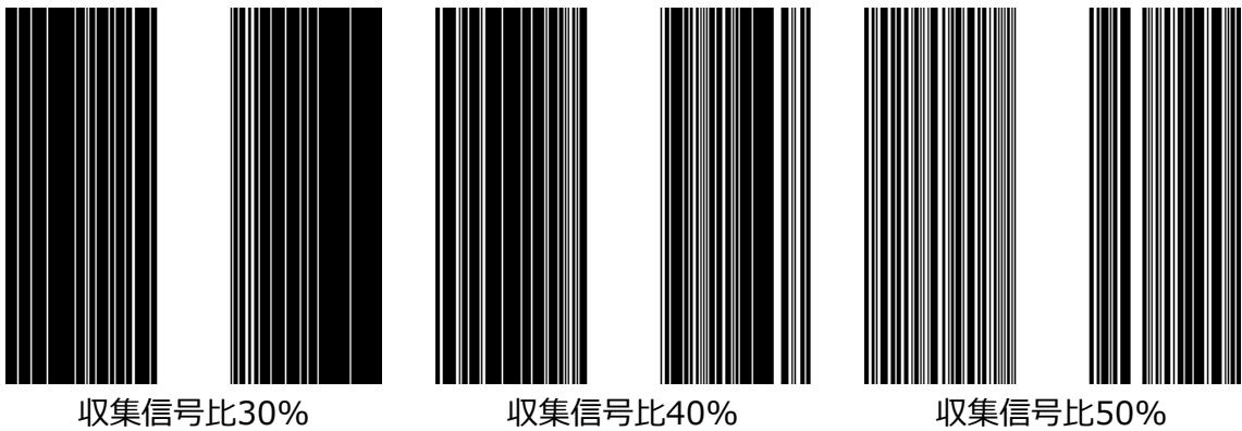
図 5.2: 実際に使用した 1 次元ランダム収集の間引きパターン
