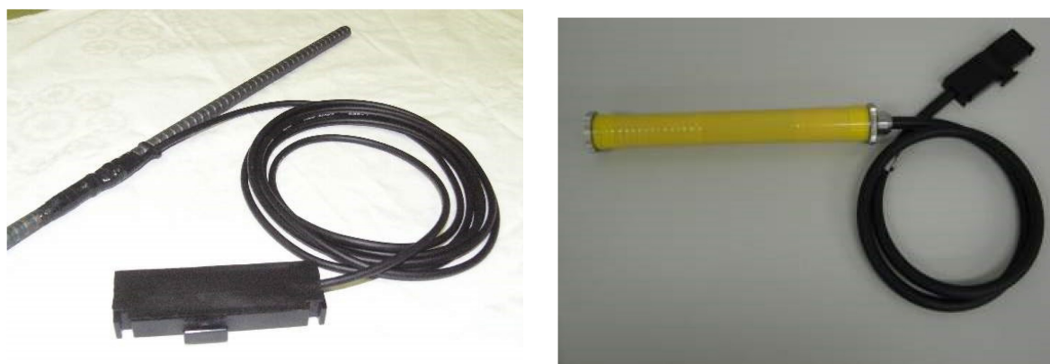
図 4-13 RFID ひずみセンサの外観 (左：鉄筋計タイプ、右：コンクリートひずみ計タイプ)
