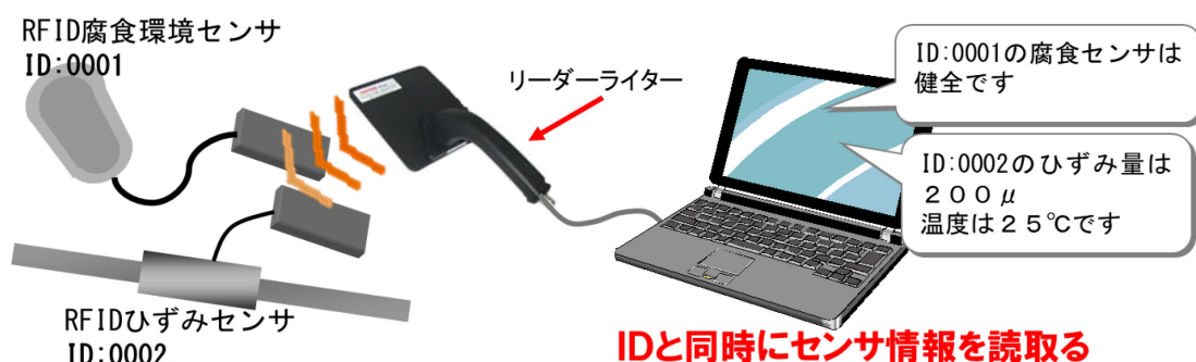
図 4-7 RFID タグとセンサを接続するイメージ
