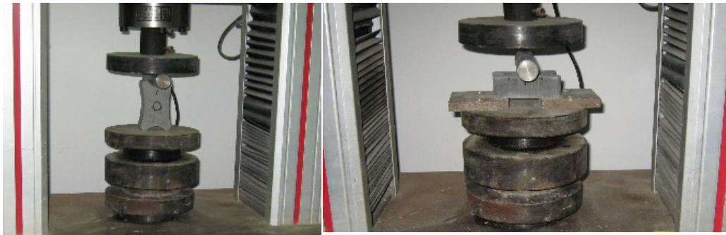
図 5-3 RFID タグを埋設したモルタルスパーサの破壊試験状況
