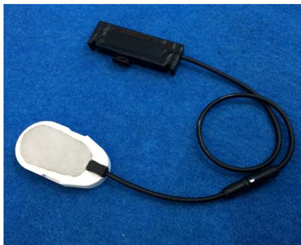
図 4-21 腐食センサの外観と構造
