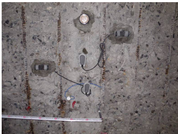
図 4-27 各種センサの設置状態
