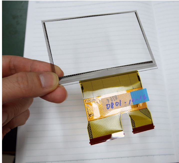
図 30 : 試作した 4.1 インチ静電触覚ディスプレイの電極基板(FPC 貼付後).
