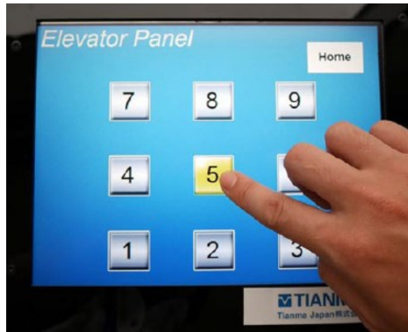
図 59：静電容量センサを一体化した静電触覚ディスプレイを 10.4 インチ LCD に積層した作製のインタラクティブ視触覚ディスプレイ。
