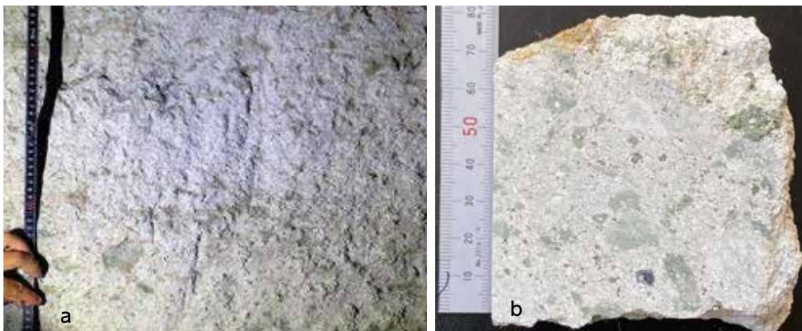
図8. 塊状の緑色火山礫凝灰岩 (a) とその切断面 (b) を示す。緑泥石化した緑色岩片の外形が一部ちぎれたような形状を示す (b)。白色の細粒凝灰岩礫や濃灰色の火山岩礫を含む (b)。
