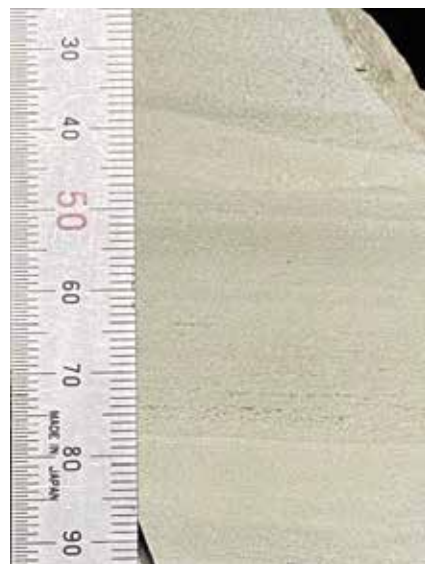
図12. 平行葉理が発達する青灰色凝灰岩. 図11の拡大. 緑泥石化した粒子が正級化を示す.
