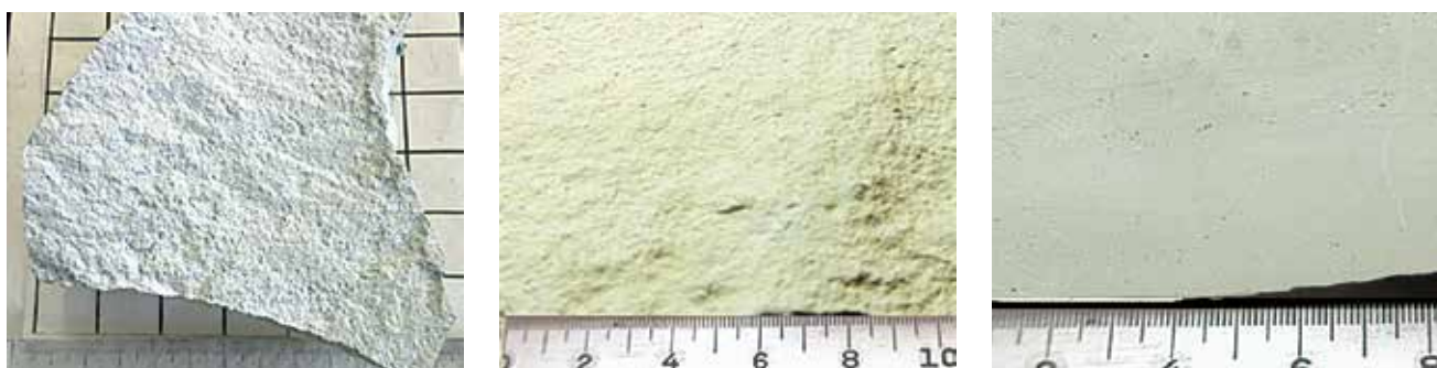
写真2. 青灰色と緑灰色の徳次郎石細粒凝灰岩 左写真の格子間隔 2 cm
