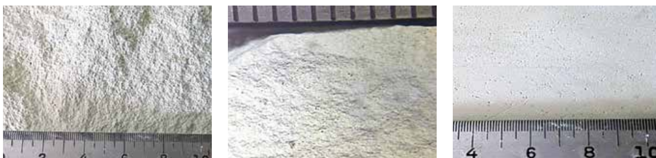
写真3. 淡褐色と灰白色の徳次郎石細粒凝灰岩
