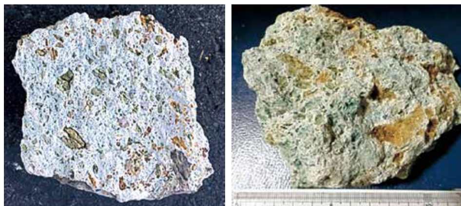
写真7. 大谷地域近傍における熊之堂石と長岡石 左：熊之堂石(池田貞夫氏試料) 横幅約12cm 右：長岡石
