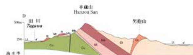
図3. 宇都宮市地域の第三系層序と地質断面図 (吉川ほか, 2010抜粋)
