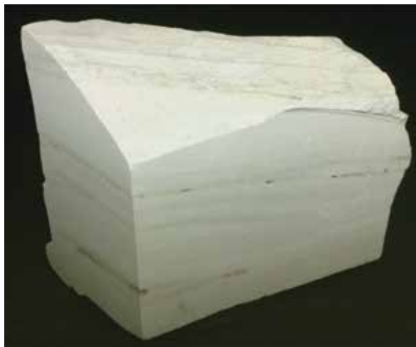
写真11. 徳次郎石の採取試料（試料の横幅約10cm） 相田吉昭氏提供
