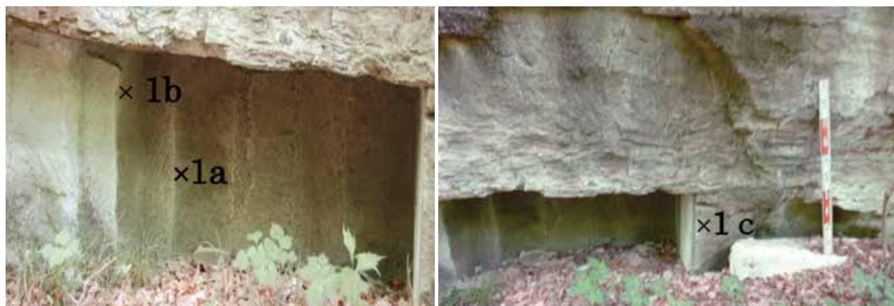
写真2. 徳次郎石の採石場跡1（Quarry1）1a, 1b, 1cはそれぞれ試料採取位置を示す。
