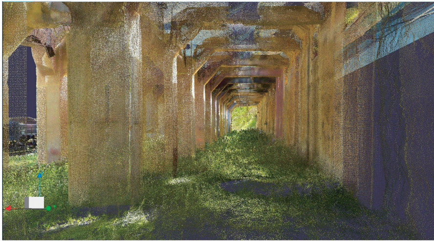
図 12 旧太子駅ホッパー内部の三次元点群データ（筆者作成）
