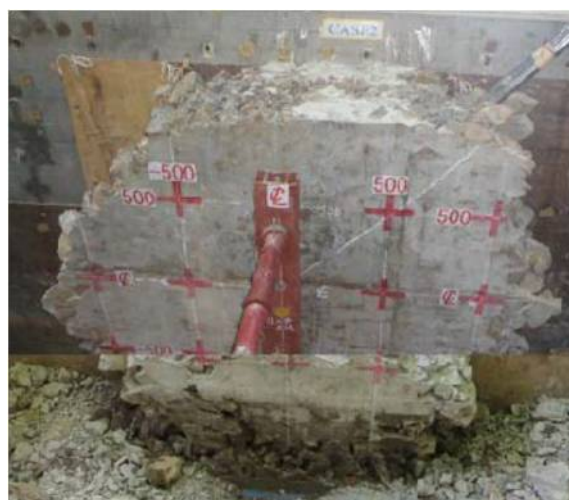
図 2.6 捨石への注入実験出来形 10)
