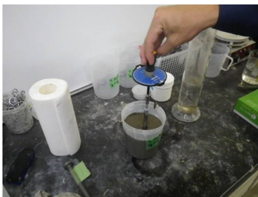
図 6.6 ベーンせん断試験
