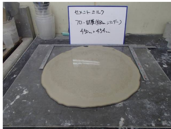
写真 2.1 流動性グラウトの例 (φ80mm シリンダーフロー)
