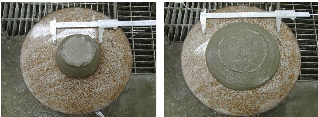
写真 2.2 可塑性グラウトの例 (φ80mm シリンダーフロー)
