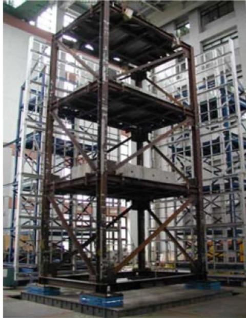
図-1.6 Tsai らの実物大の振動台実験装置 (図の出典：文献<sup>9)</sup>)
