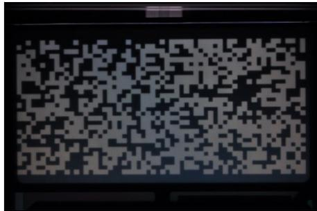
Fig. 4.13. 中面の液晶パネルにランダムパターンを表示.
