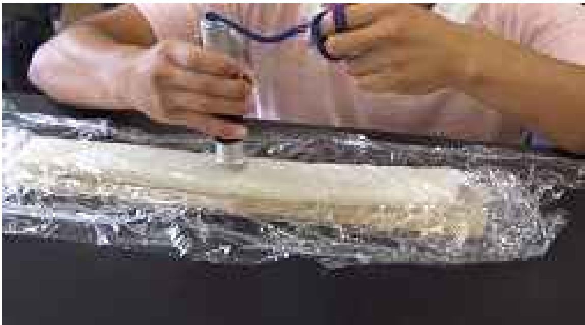
第4図 果実硬度計による計測.
