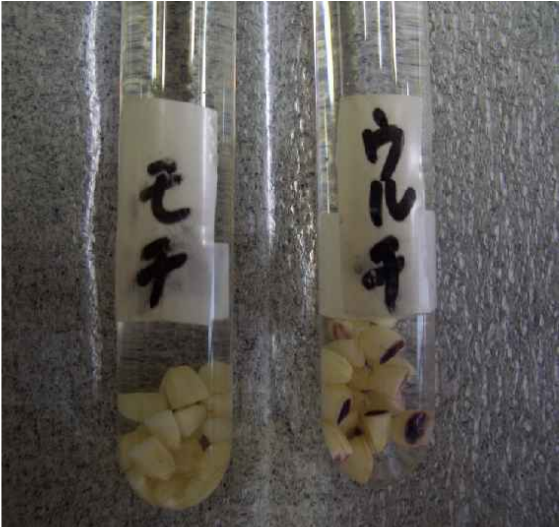
第5図 ヨード・ヨードカリ反応によるwax(モチ, ウルチ性)試験 .
