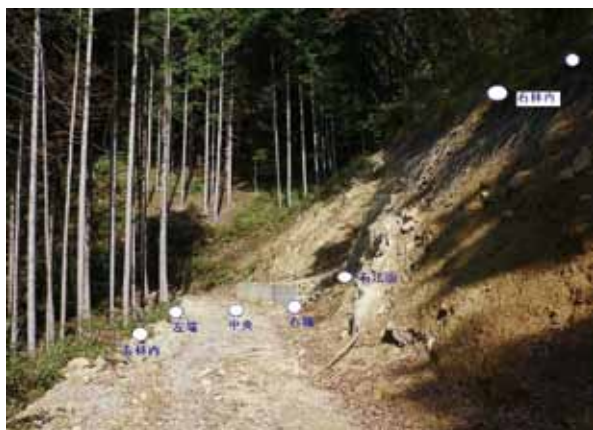
図-2.4 横断測量の位置の例
