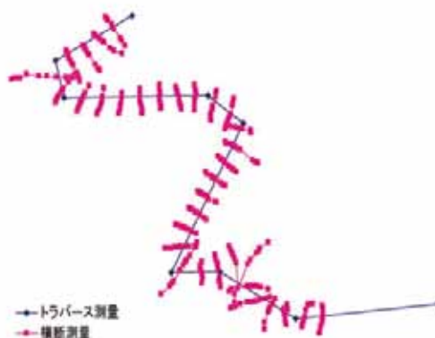
図-2.6 横断測量点の配置図
